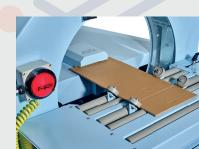
2. Das zu verpackende Produkt oder mehrere Produkte werden auf das zuvor positionierte Tray gelegt.
